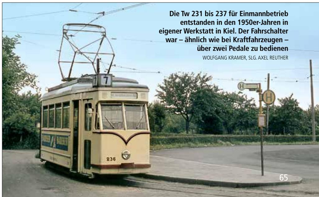
Die Tw 231 bis 237 für Einmannbetrieb entstanden in den 1950er-Jahren in eigener Werkstatt in Kiel. Der Fahrshalter war – ähnlich wie bei Kraftfahrzeugen – über zwei Pedale zu bedienen
