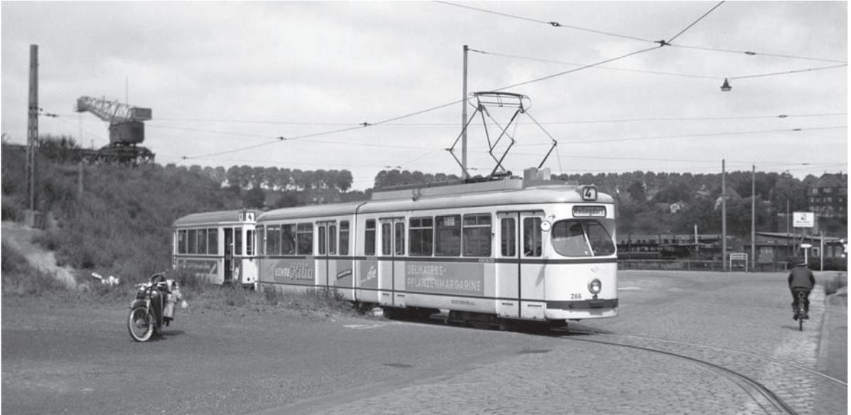
Der moderne Gelenktriebwagen 266 in den ersten Einsatzjahren Anfang der 1960er Jahre bei der Ausfahrt aus der Wendschleife in der Wik am Kanal (Schleusenstraße/ Uferstraße) mit einem zweiachsigen Beiwagen aus dem Jahr 1939. An Stelle einer Erweiterung des Sechssachser zum Achtsachser wählte die KVAG Mitte der 1960er Jahre die Modernisierung der veralteten Zweiachser. So war das Gespann bis 1985 in Kiel im Einsatz. (Dieter Walking, Archiv Axel Reuther)
